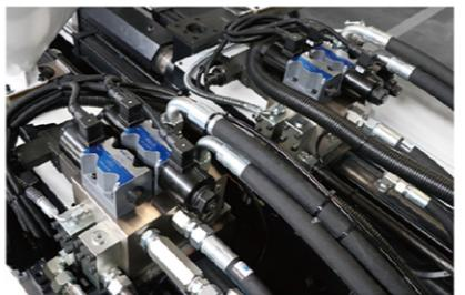
▶ 采用DIN标准锥面带密封圈接头，阀板采用G螺纹密封堵头，以杜绝油质污染。
