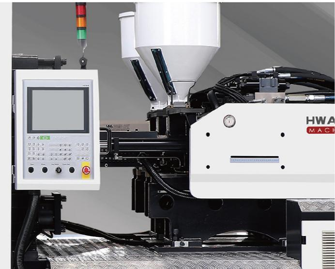
▶ 伺服电机控制转盘，高效节能，精确稳定。
